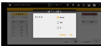
Gestiona el paso de corriente por cada una de las entradas para alimentar antenas o previos conectados, cuando la señal captada lo requiera.
