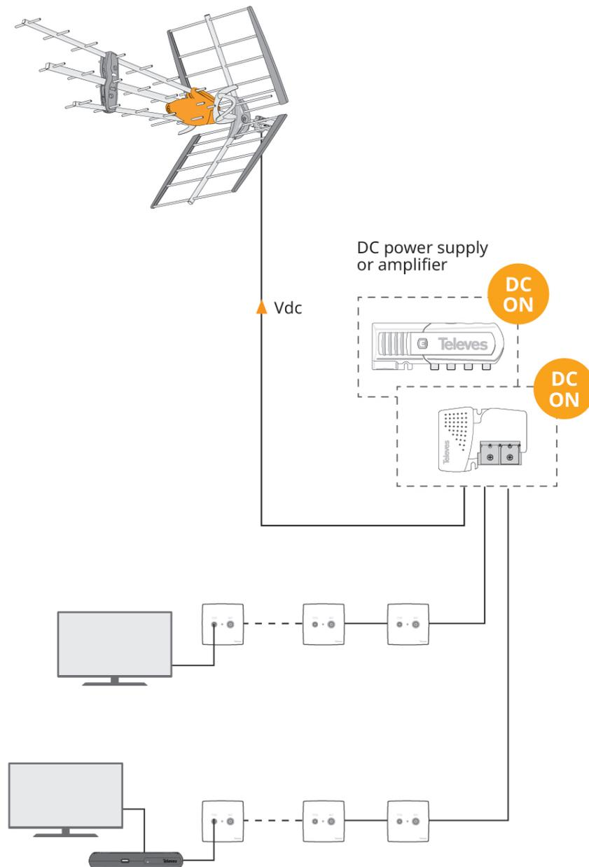
Activación del BOSS mediante fuente de alimentación o amplificador .
