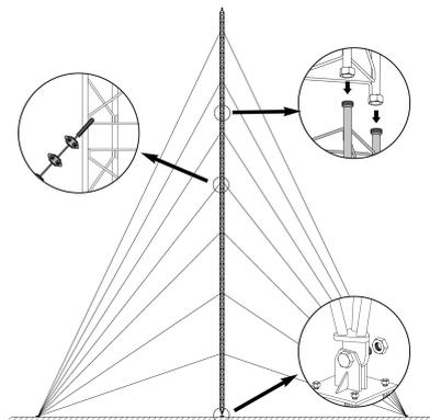
Consiste en fijar a la base el tramo inferior y colocarlo en posición vertical nivelándolo. Posteriormente se van montando los tramos intermedios sucesivos, que estarán equipados con los vientos correspondientes; el montaje se realiza escalando los tramos ya colocados e izando posteriormente el tramo que se va a colocar, ayudándose de utillaje de elevación adecuado.
