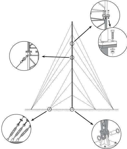
Consiste en fijar a la base el tramo inferior y colocarlo en posición vertical nivelándolo. Posteriormente se van montando los tramos intermedios sucesivos, que estarán equipados con los vientos correspondientes; el montaje se realiza escalando los tramos ya colocados e izando posteriormente el tramo que se va a colocar, ayudándose de utillaje de elevación adecuado.
