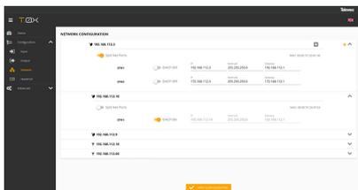
Cada unidad dispone de dos conectores Ethernet RJ45, los cuales pueden utilizarse en una única red o bien en dos redes separadas, una para control y otra para la distribución de video. Se puede habilitar la separación de estas redes (Split Net Ports) y configurar, para cada una, la dirección IP, la máscara de subred y la puerta de enlace por defecto, así como configurarlo como cliente DHCP.
