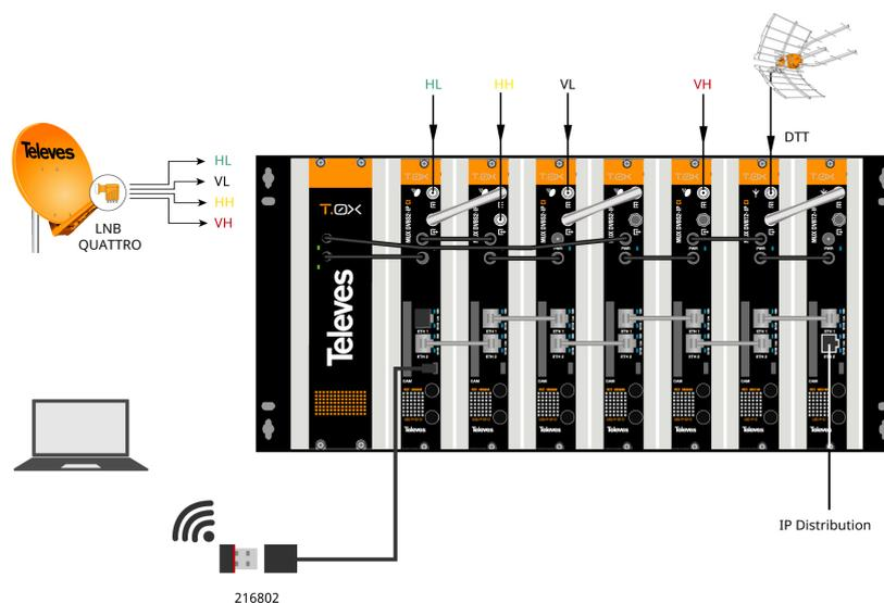
Questo adattatore deve essere collegato alla porta micro USB sulla parte anteriore dell'unità. Dopo un processo di inizializzazione automatica, sarà possibile connettersi a una rete Wi-Fi, a condizione che il suo SSID abbia il seguente formato: Televes\_mng\_XXYYZZ. Per accedere al sito Web di configurazione, aprire un browser e accedere all'URL "config.t0x".
