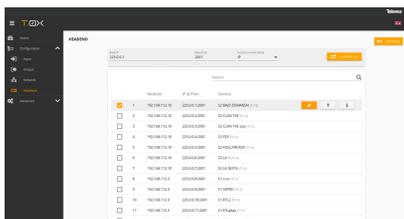
È possibile aggiungere più servizi contemporaneamente selezionando un indirizzo IP di base e una porta di base, come i servizi desiderati, e un indirizzo IP o auto-incremento della porta. L'interfaccia Web genererà automaticamente gli indirizzi IP multicast di ciascuno dei servizi, in termini di parametri selezionati.
