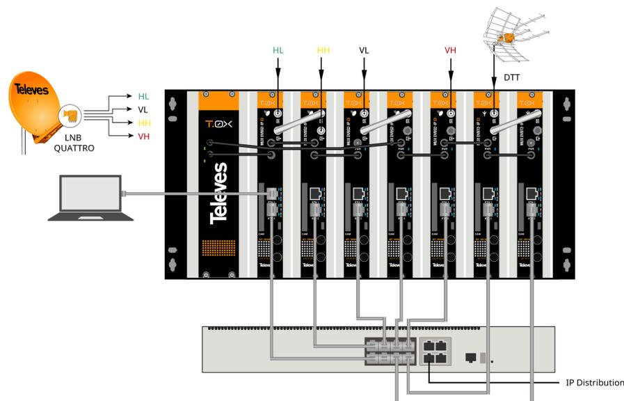
Collega le uscite ETH2 delle unità allo switch di distribuzione video esterno con cavi Ethernet CAT6.(\*) Il bitrate massimo per unità è 150 Mbps. Il bitrate massimo con unità in loop è 500 Mbps.
